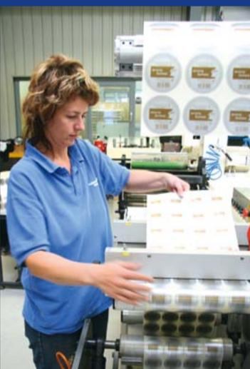
Die Konfektionierung ist die letzte Station des Produktionsdurchlaufes. Hier werden die gedruckten Etiketten komplettiert.
